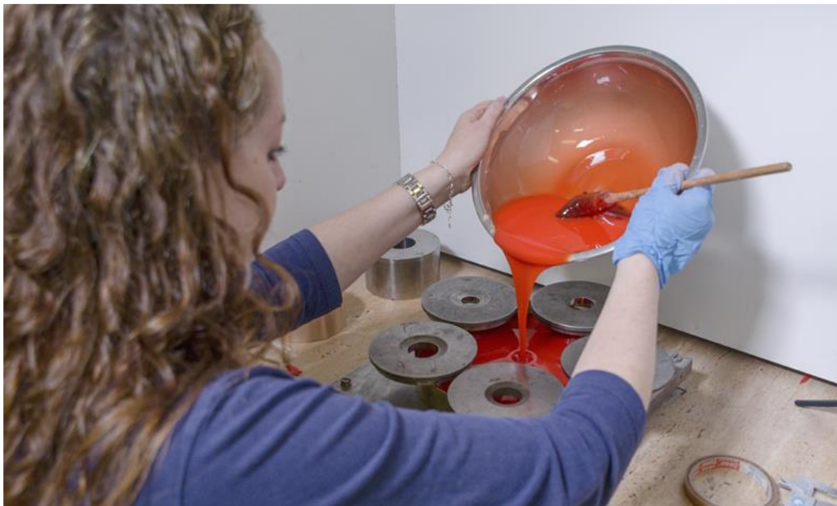
výroba pryskyřicového odlitku ze silikonkaučkové formy
