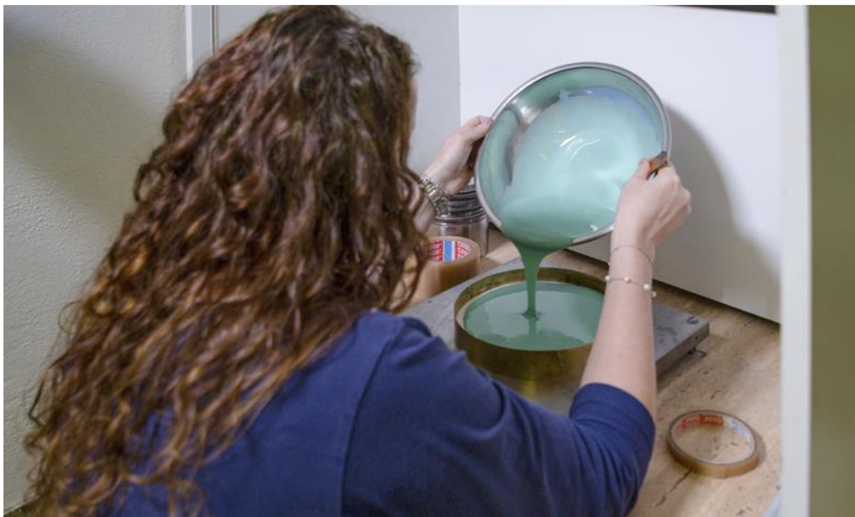
výroba silikonkaučkové formy ze sádrového modelu
